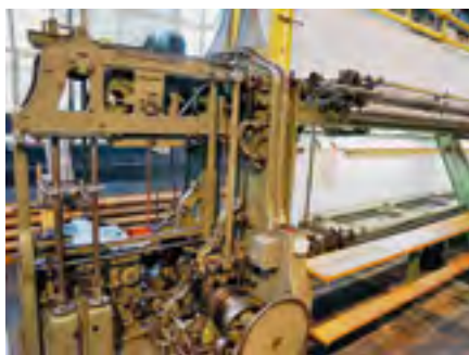
Die «modernste» Stickmaschine wird von einem bereits 1912 gebauten «mechanischen Computer» gesteuert und stickt wunderschöne Sankt Galler Stickereien.
