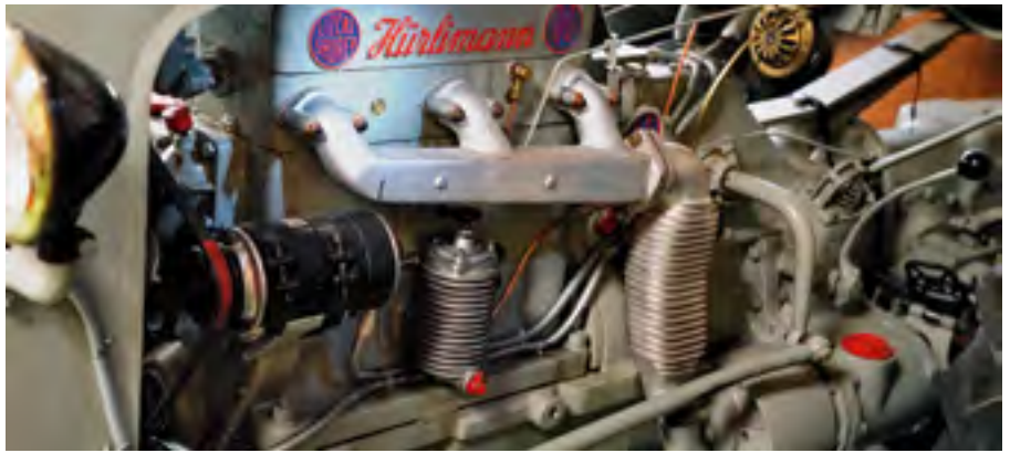
In Hürlimann Traktoren wurden zeitweise Lizenzbau-Motoren von Saurer, wie dieses Modell «4 DB 85», entwickelt von Ingenieur Ariste Liengme, verbaut.
