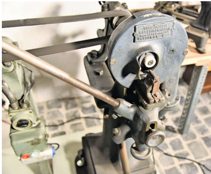
Auf der Bohrerschleifmaschine aus der Vogtländischen Maschinenfabrik wurden die kantigen Stahlstifte für die Lochstickerei (Bohrware) geschärft. Bild: Willi Keller
