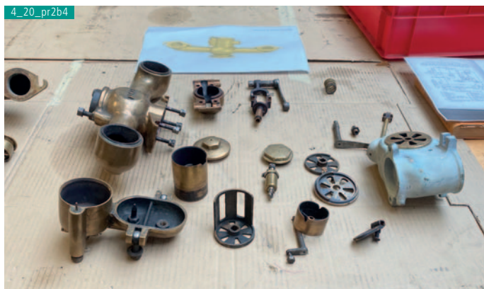
Bild 4. Im Lager Ersatzteile holen ist in diesem Fall nicht möglich. Der Vergaser muss erst wieder aufwendig nachgebaut werden.
