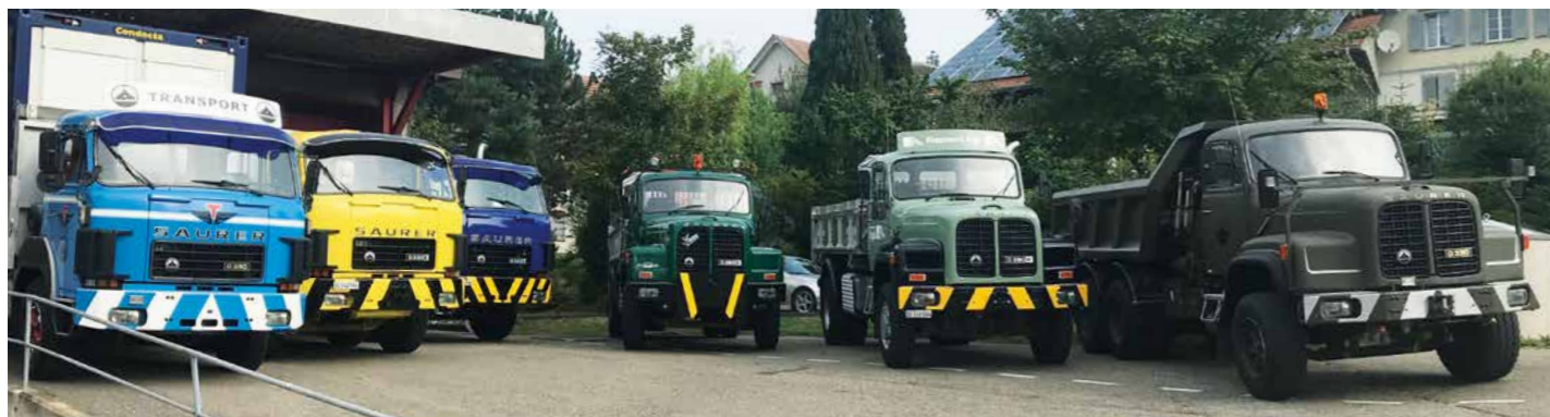
Typenreine Saurer Flotte 2018 vor der Einstellhalle in Lömmenschwil: D290 F 4x2 1980, D330 BF 8x4 1980, D330 BF 4x2, D290 BN 4x2 1981 und D290 BN 4x4 1983 (von links).
