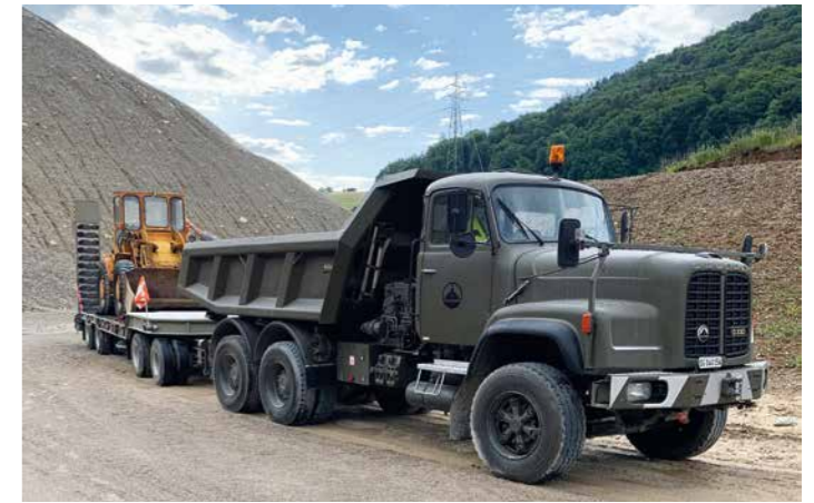
Der Saurer D330 6x4 Muldenkipper 1980 mit Tiefbettanhänger wird auch für Schwertransporte eingesetzt.
